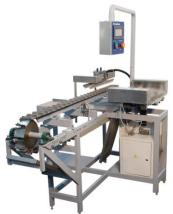
**Машина дозировки начинки в круассаны ДМН-2К** предназначена для набивки различными массами:
