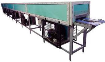
**Конвейер охлаждающий ОК-1-8** предназначен для механизации процесса охлаждения мармелада на предприятиях пищевой промышленности.
